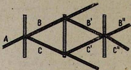
Рис. 1. Ход лучей в интерферометре.
