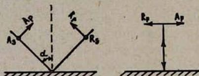
Рис. 3а — Отражение под углом  $\alpha \neq 0$ .
