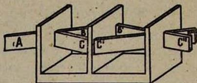
Рис. 2. Схема интерферометра.
