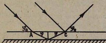
Рис. 6. Схема отражения рентгеновых лучей от тонкого слоя.
