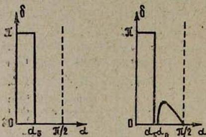
Рис. 4а. Отражение от более плотной среды.
