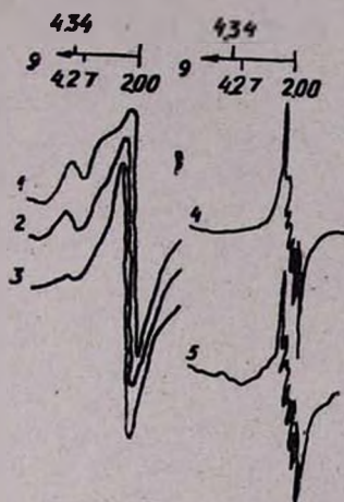
Рис. 4. Спектры ЭПР \text{Mn}^{2+} в стеклах различного состава при комнатной температуре. 1 — \text{Li}_2\text{O} \cdot 2\text{SiO}_2 \cdot 2\text{MnO}_2 [13]; 2 — \text{Na}_2\text{O} \cdot 2\text{SiO}_2 \cdot \text{MnO}_2 [13]; 3 — \text{K}_2\text{O} \cdot 2\text{SiO}_2 \cdot 2\text{MnO}_2 [13]; 4 — 35\text{BeF}_2 \cdot 20\text{AlF}_3 \cdot 20\text{CaF}_2 \cdot 15\text{SrF}_2 \cdot 20\text{MgF}_2 \cdot 0,05\text{MnF}_2 ; 5 — \text{ZnO} \cdot \text{P}_2\text{O}_5 \cdot 0,05\text{MnO}_2 [13].
