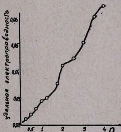
Рис. 3. Кривая зависимости удельной электропроводности фильтрата от n .
