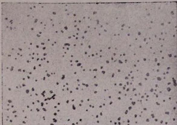
Рис. 5. Электронно-микроскопический снимок образца хлоропренового латекса, полученного при температуре 10° без применения „затравки“.
