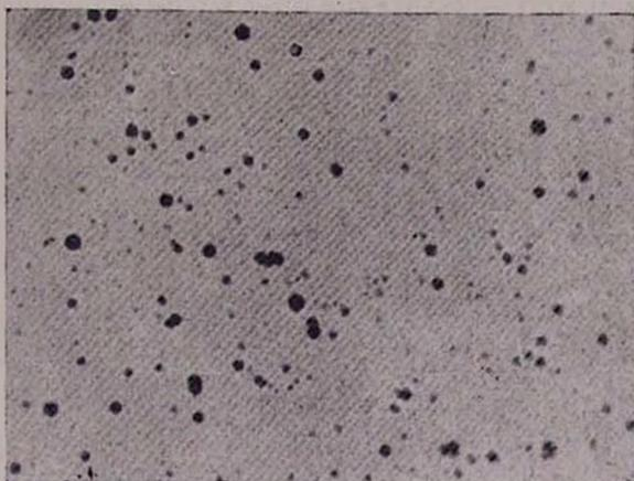
Рис. 6. Электронно-микроскопический снимок образца хлоропренового латекса, полученного при температуре 10° в присутствии „затравки“.
