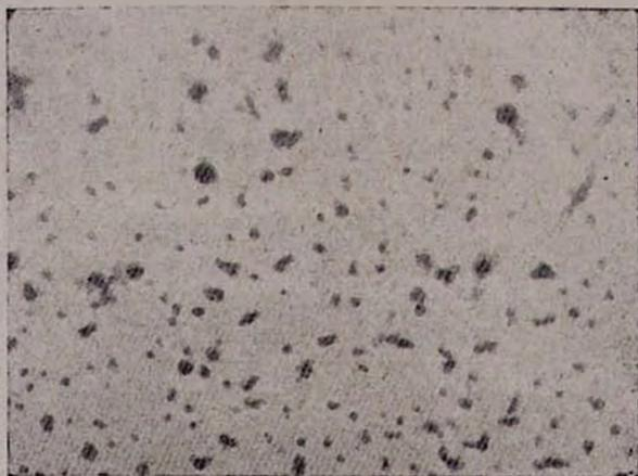
Рис. 1. Электронно-микроскопический снимок образца хлоропрен—изопренового латекса, полученного без применения „затравки“.
