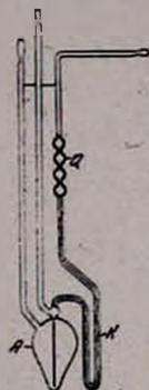
Рис. 1. Новый капиллярный вискозиметр для исследования зависимости вязкости растворов полимеров от градиента скорости; K — капилляр, Q — измерительный шарик, A — резервуар.
