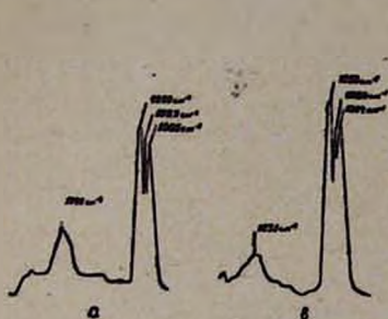
Рис. 1. Спектрограмма метилового спирта, полученная на ИКС-14. а) в продуктах реакции, б) чистого метилового спирта.
