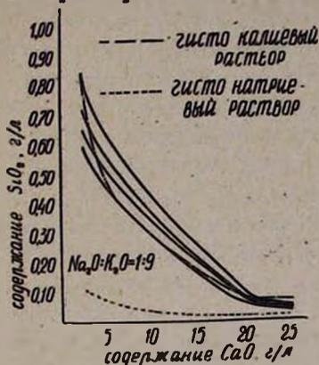
Рис. 2. Обескремнивание алюминатных растворов, содержащих 3,7 г/л SiO<sub>2</sub>, с соотношением Na<sub>2</sub>O : K<sub>2</sub>O = 1 : 9.
