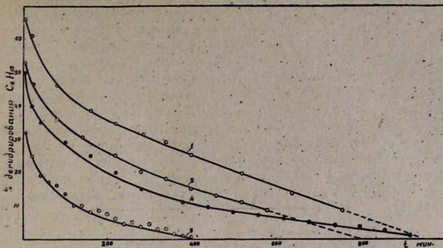
Рис. 1. Зависимость скорости дегидрирования от времени: 1—катализатор № 1 (1,0% палладия от веса SiO<sub>2</sub>); 2—катализатор № 3 (1,0% палладия от веса SiO<sub>2</sub>; Pd:Ag=4:1); 3—катализатор № 8 (0,2% палладия от веса SiO<sub>2</sub>); 4—катализатор № 10 (0,2% палладия от веса SiO<sub>2</sub>; Pd:Ag=4:1).
