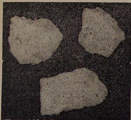
Рис. 6. Вид кусков стекловидного базальта после выщелачивания азотной кислотой; увелич. в 3 раза.
