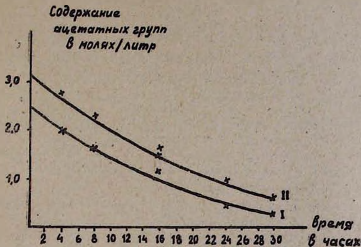
Рис. 2. Кинетические кривые (температура 63° С, катионит МСФ—3,30% к весу полимера). I—лак 25% конц., II—лак 33% конц.
