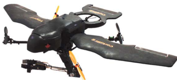
Рис. 3. БПЛА с ВВП с развязкой по тангажу и роботом-манипулятором.
