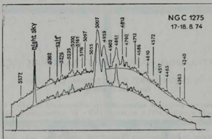
Рис. 1. Спектрограммы NGC 1275 за 17—18.8.1974 г. в области длин волн 5600—4300 Å. Оригинальная дисперсия 110 Å/мм.
