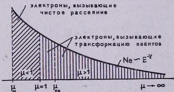
Рис. 3. К выводу теоретического спектра вспышки в случае немонохроматического потока электронов.
