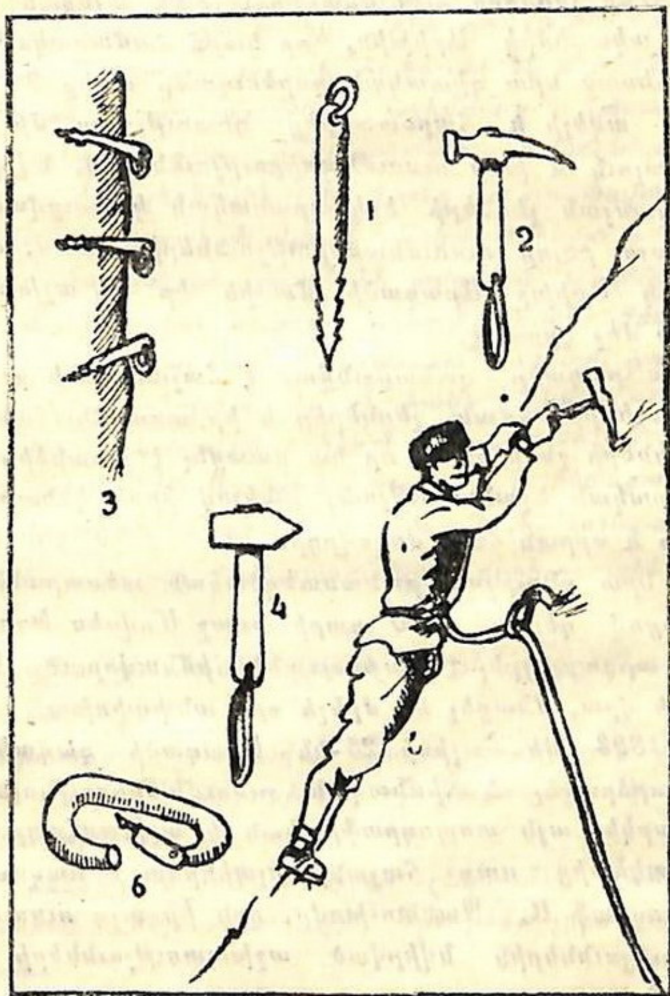
Նկ. 2. Ալտինիդի տեխնիկա. 2. ժայռային մուրճ, 1. ժայռյա կեռ, 4. սառցյա մուրճ, 5. ժայռային տեխնիկա, 6. փական:
