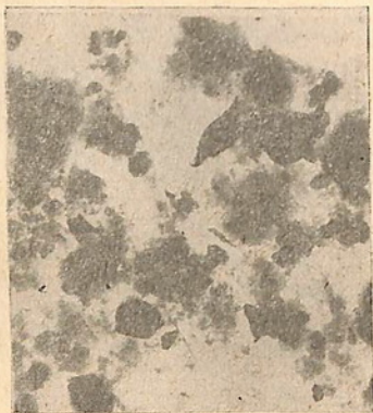
Рис. 4. Электронномикроскопический снимок обр. № 84. Пестроцветная толща. Видны чешуйки хлорита (с интенсивно размытыми краями) и гидрослюда. \times 8000 .
