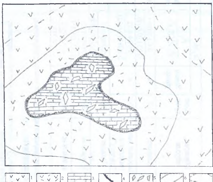
Рис. 2. Схема зонального ореола Sr x Ba в трахибазальтах на контакте с тектоническим погребом (Мюришенская группа проявлений): 1. – трахибазальты; 2 – измененные трахибазальты; 3-карбонатная порода гидротермального происхождения; 4 - зональная оторочка погребов; 5 - скаленоэдры кальцита; 6-7 - части ореола: 6 - тыловая; 7 - фронтальная.
