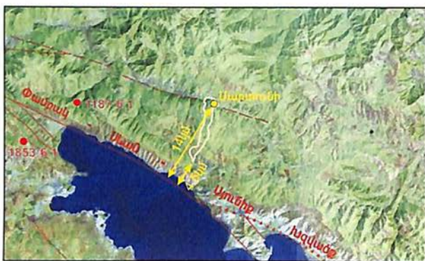
Նկար 4.13. Մարտունու սողանքի տեղադիրքը Փամբակ-Սևան-Սյունիք ակտիվ խզվածքի և մոտակա ուժեղ երկրաշարժերի էպիկենտրոնների համեմատ:
