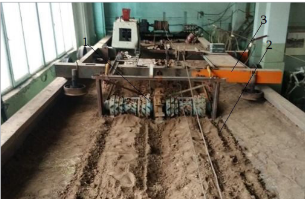
Նկ. 2. Ռոտորային կոշտամանրիչի աշխատանքը լաբորատոր գիտափորձի ժամանակ.
