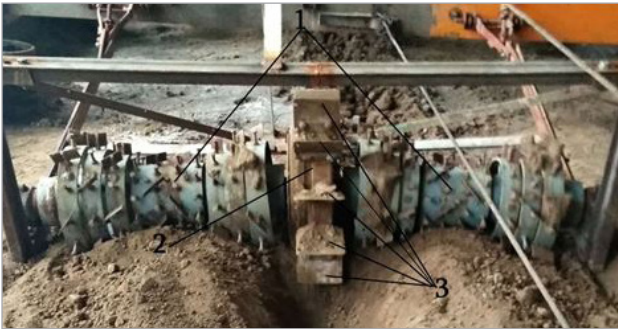
Նկ. 1. Շարժաբեր թմբուկով ռոտորային կոշտամանրիչի ընդհանուր տեսքը.
