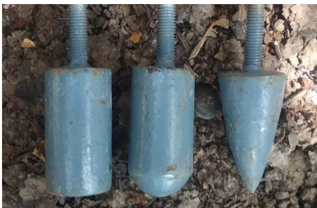
Նկ. 2. Կարտոֆիլահանի կոշտամանրիչի փորձարկվող մատներ (Ա.Պ. Թարվերդյան և ուրիշ., 2020):
