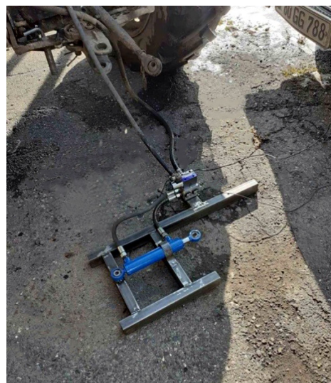
Նկ. 3. Բանող օրգանների էլեկտրամեխանիկական եղանակով կառավարման մեխանիզմը փորձարկման ժամանակ:
