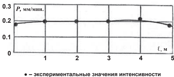
Рис. 5. График изменения интенсивности дождя в дождемерах в зависимости от их удаления от стояка дождевального устройства (составлен автором).
