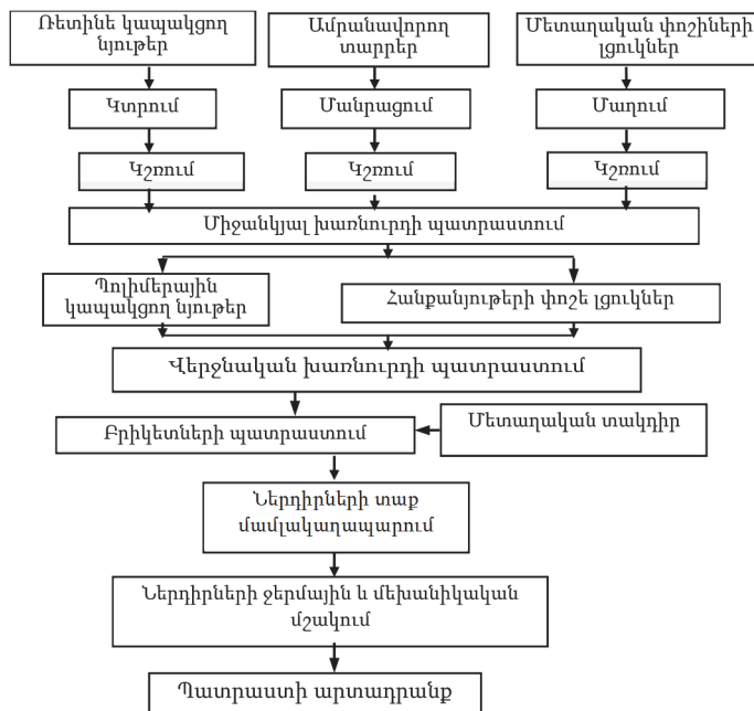
Նկ. 7. Բաղադրիչների խառնման երկփուլ տեխնոլոգիայով Բաստենիտ-9 շփանյութից արգելակային ներդիրների արտադրության տեխնոլոգիական սխեման
