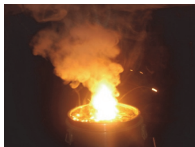
Նկ. 1. Ֆերոմոլիբդենի ստացումը բովախառնուրդի այրման պահին
