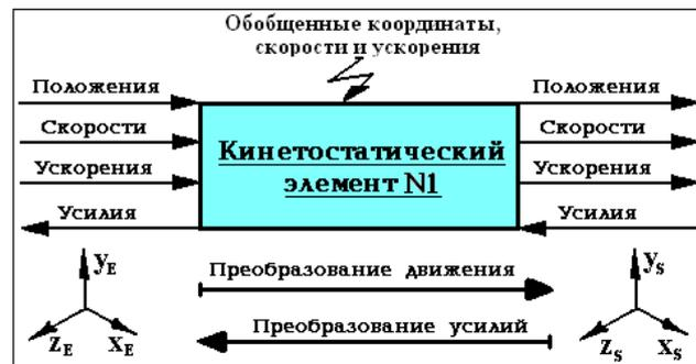
Рис. 2. Функциональная схема кинестатического элемента первого типа
