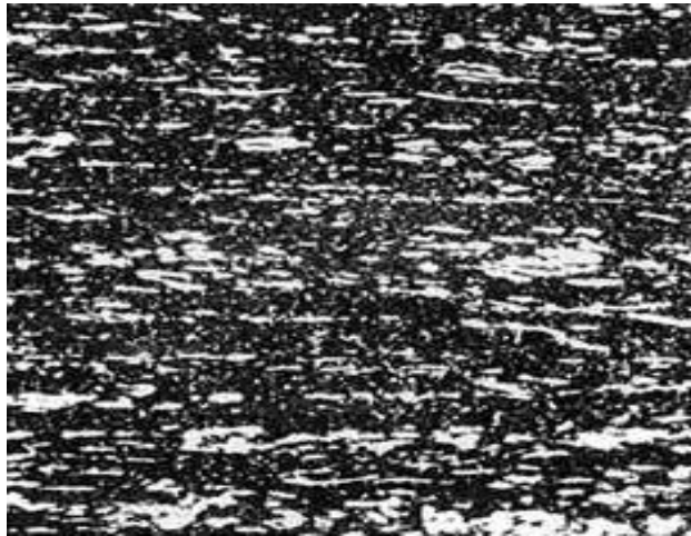
Նկ. 13. 4% Cu+1,8 % Mg+1,2% Cr+4,5% MoS 2 +Al 0.05 բաղադրությամբ ալյումինային հակաշփական փոշեհամաձուլվածքի շփման մակերևույթի մակրոկառուցվածքը (x50)՝ P=5 կգ, V=1,2 մ/վ (500 պտ/րոպե), սահմանային շփում
