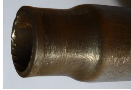
Рис. 1. Схема прессования трубы в конической матрице (а) и прессовка (б)
