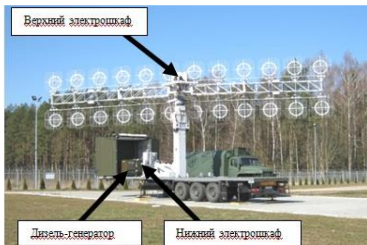
Рис. 7. Основные единицы подсистемы энергоснабжения и автоматического управления
