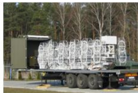
Рис. 2. Фотоснимок антенной системы в свернутом состоянии
