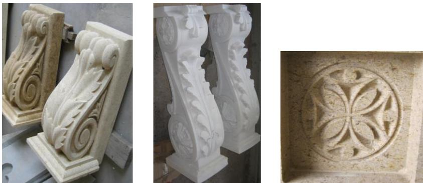
*Рис. 3. Сложнопрофильные изделия, изготовленные на станке с ЧПУ*
