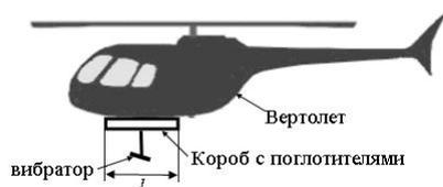
Рис. 7. Конфигурация системы “вертолет–короб–вибратор”
