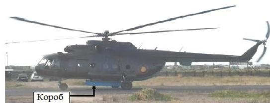
Рис. 8. Закрепленный под днищем вертолета короб
