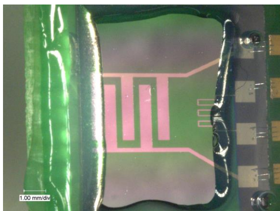
Рис. 2. Вид и размеры электродов
