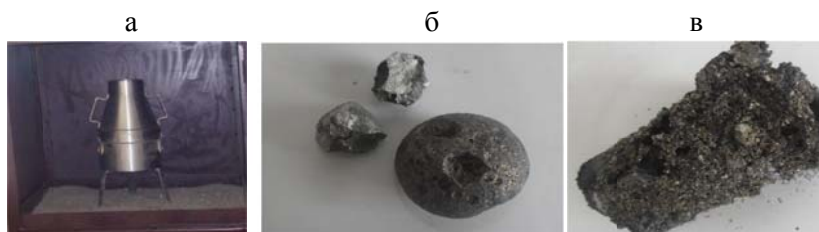
Рис. 1. Лабораторная СВС установка (а), металлические (б) и шлаковые (в) фазы
