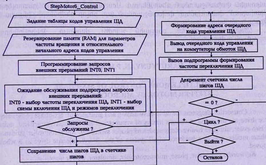
Рис.8. Алгоритм программы управления ШД
