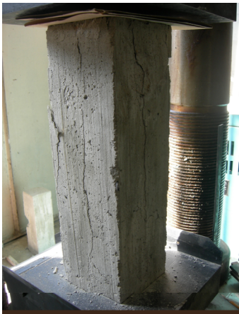
Նկ. 4. Բետոնի պրիզման քայքայման պահին
