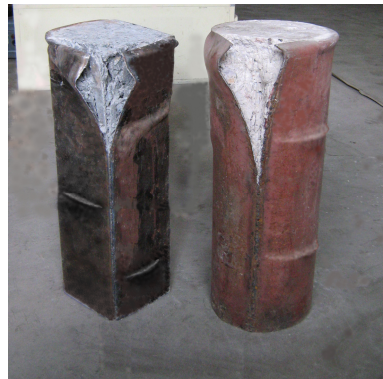
Նկ. 7. Ուղղանկյուն և կլոր կտրվածքի խողովակաբետոնների քայքայումը զոդման կարերով
