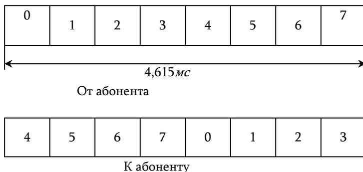
Рис 4. Временные окна радиоканала GPRS
