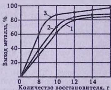
Рис. 2. Зависимость выхода металла от количества восстановителя при различных продолжительностях измельчения: 1 - 15 мин., 2 - 30 мин., 3 - 60 мин.
