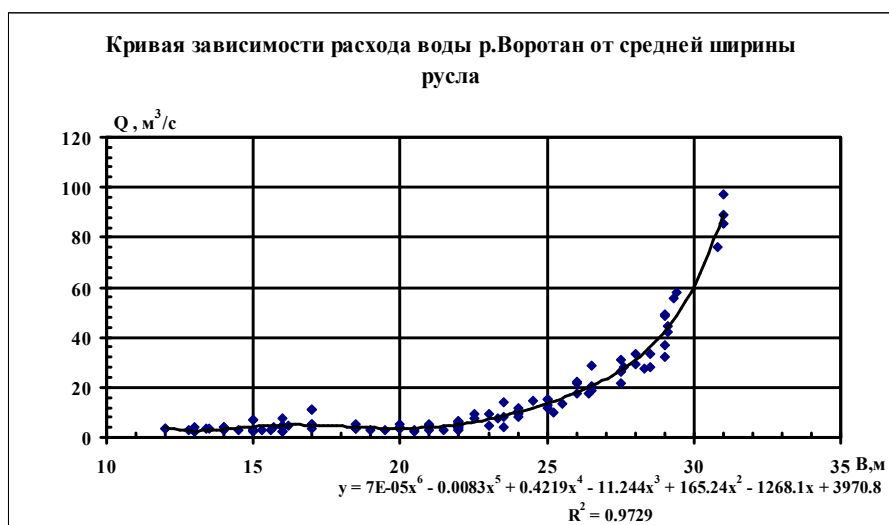
Рис.1. Морфометрические зависимости р.Воротан в створе с.Борисовка
