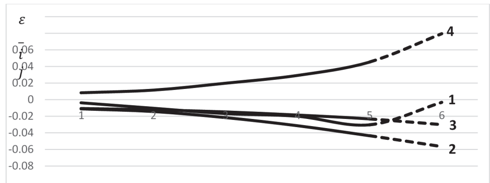
Նկ. 8. ռ-ռ հատույթի վերնի տարրերի տվյալներով կառուցված դեֆորմացիաների բաղադրիչների գրաֆիկները (1 - սահքի, 2 - շառավղային, 3 - շրջանային և 4 - առանցքային)
