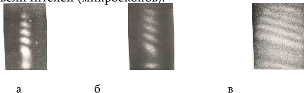
Рис. 6. Муаровая картина: а - образованная трехкристальной системой; б - увеличенная картина 5а без сканируемой щели и рентгеновской пленки; в - увеличенная картина 5а при сканируемой щели и рентгеновской пленке
