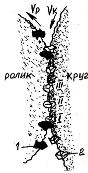
Рис.2. Схема контактирования алмазного ролика с шлифовальным кругом :
