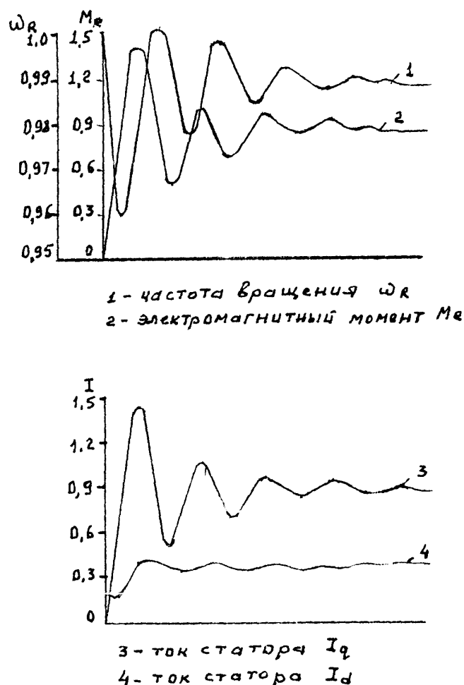
Рис. Кривые токов, частоты вращения и электромагнитного момента нагрузки на двигатель мощностью 75 кВт, работающий в режиме идеального холостого хода
