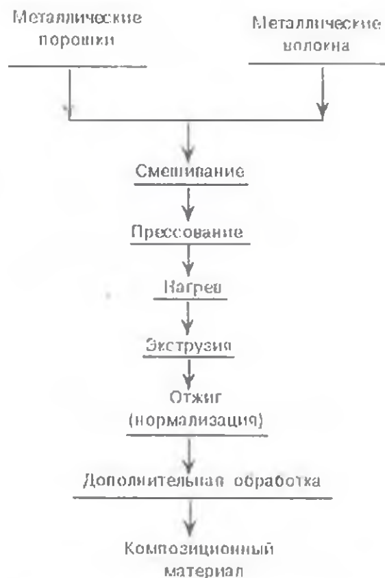
Рис. 1. Общая технологическая схема получения композиционных материалов, армированных волокнами, путем экструзии
