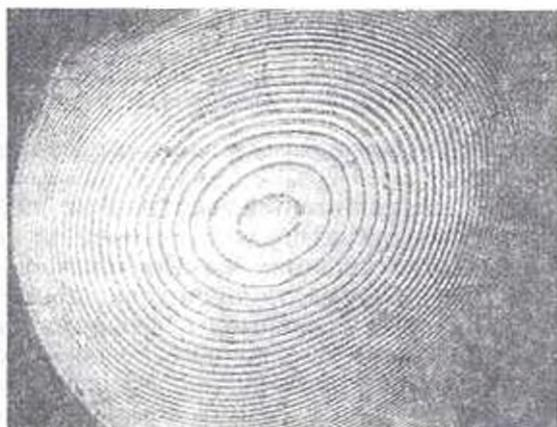
Рис. 2. Типичная интерферограмма формы деформации пластин
