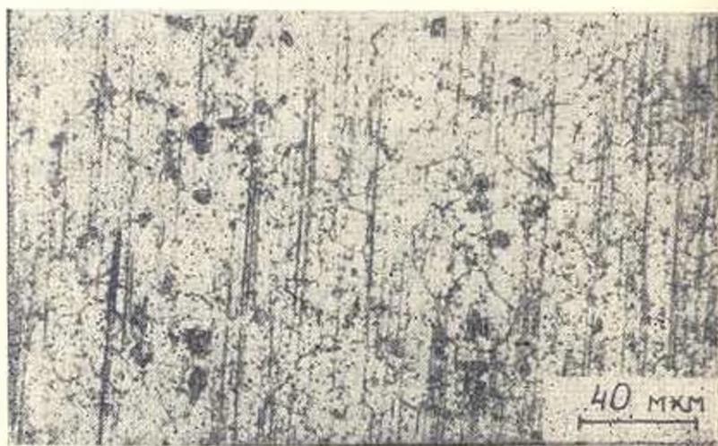
Рис. 1. Микрорельеф поверхности образца цермета: а) до (1) и после (б) термического отжига.
