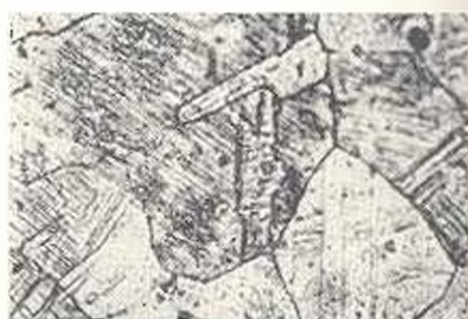
Рис. 2. Микроструктура крупнозернистой стали X18H10T после циклической деформации при 20°C ( 2\Delta\epsilon = 2\% , N = 1970 циклов), \times 300 .
