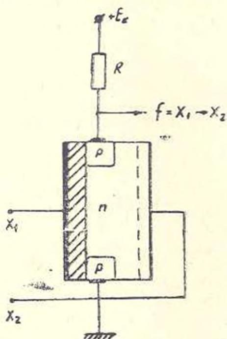
Рис. 2. Принципиальная электрическая схема импликатора на МДП-транзисторе
