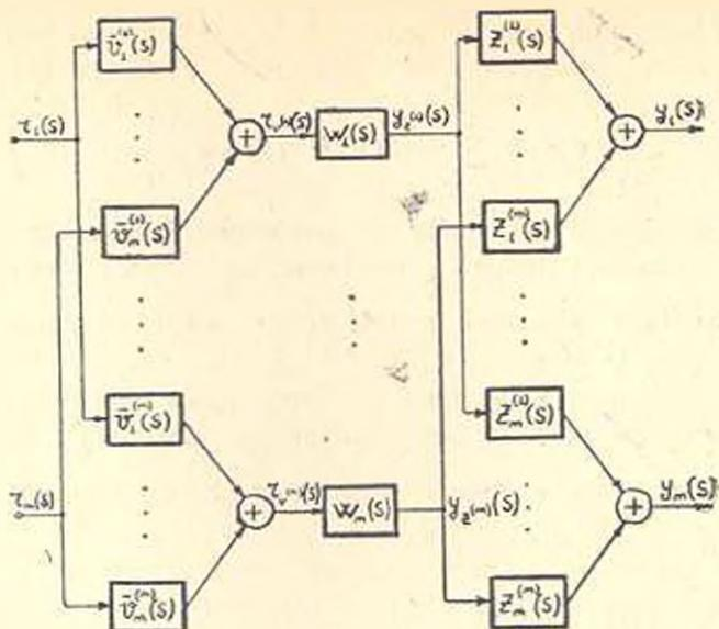
Рис. 1. Развернутая скалярная структурная схема линейной МСАУ.
