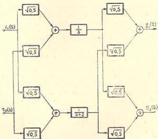
Рис. 2. Развернутая скалярная структурная схема линейной двумерной САУ.
