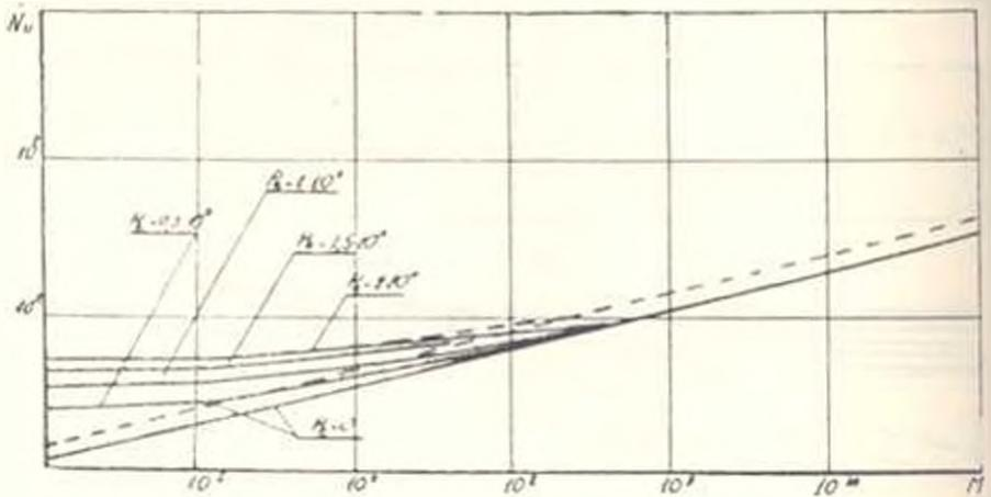
Рис. 2. Функциональная зависимость  $\bar{Nu} = f(M)$  для трансформаторного масла при  $Re = 0 - 2 \cdot 10^5$ ; —  $K=1$ ; - - -  $K=2.351$  ( $\theta_w = 50^\circ C$ ).
