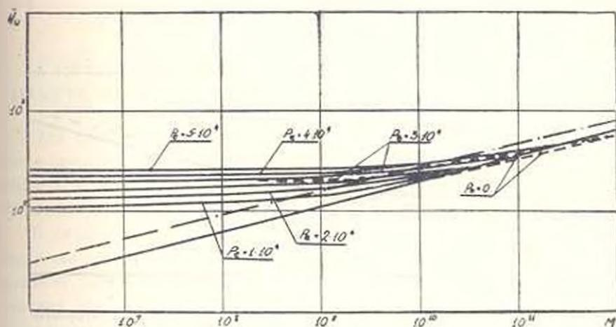
Рис. 1. Функциональная зависимость  $\overline{Nu} = f(M)$  для воздуха, при  $Re = 1 \cdot 10^4$ ,  $5 \cdot 10^4$  и  $Re = 0$ ; —  $K = 1$ ; ----  $K = 0,9018$  ( $\theta_n = 100^\circ C$ ); — расчет по формуле [1].
