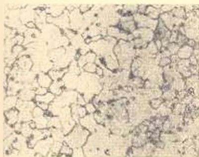
Рис. 1. Микроструктура отожженных образцов-электродов ( \times 500 ). Время отжига: материал „А“ — а) 1 час; б) 2 часа; в) 4 часа; г) 8 часов; материал „В“ — д) 1 час; е) 2 часа; ж) 4 часа; з) 8 часов.
