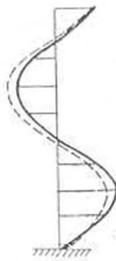
Рис. 4. Формы колебаний модели в поперечном направлении: ————— экспериментальные; - - - - - расчетные.
