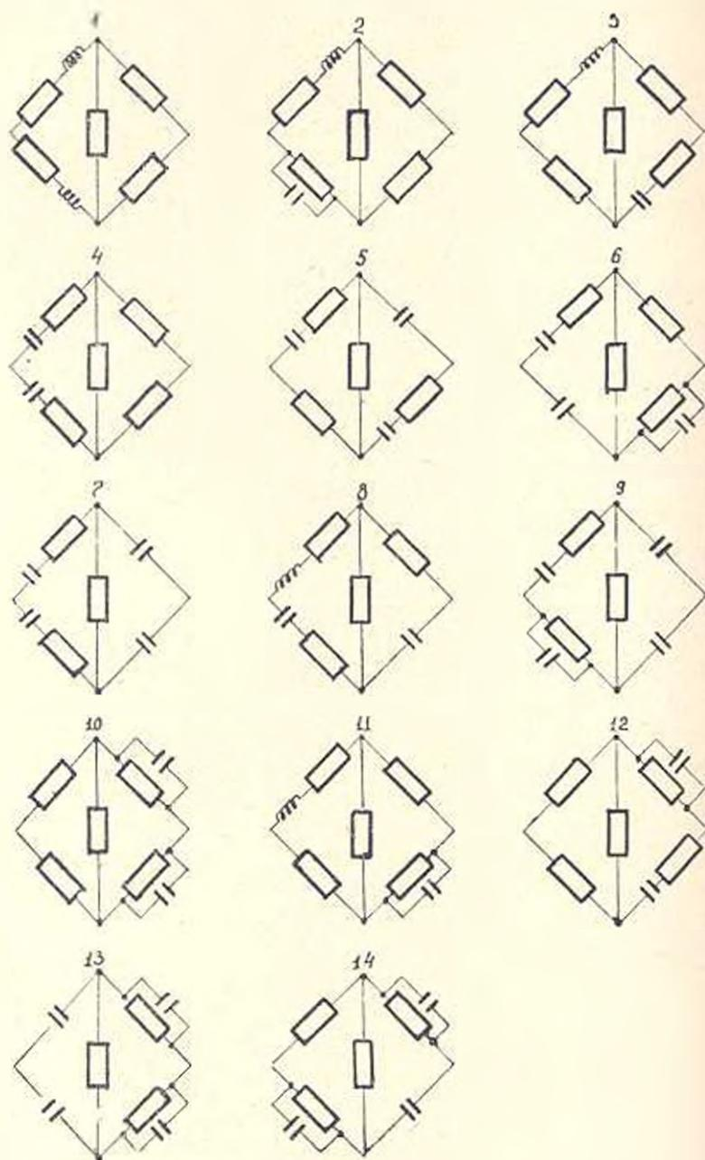
Рис. 2. Схемы измерительных цепочек:
