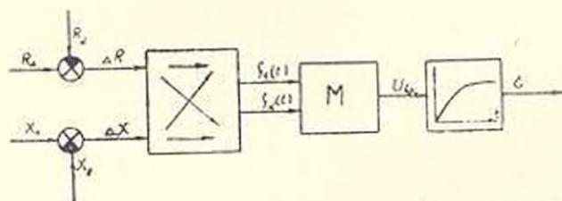
Рис. 3 Структурная схема линейризованной мостовой цепи (М—модулятор)
